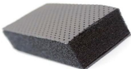
Revestimiento de PVC beige perforado, espuma de poliuretano absorbente ignifuga M-1 y masa pesada visco elastica de 5 kg/m<sup>2</sup>
