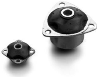
El soporte antivibratorio A.T. está especialmente concebido para efectuar el aislamiento en medias y altas frecuencias. Está constituido de un casquillo de caucho entre dos armaduras tubulares concéntricas. La armadura interior es un tubo cilíndrico. La armadura exterior es también tubular, llevando una brida en la que se pueden efectuar los taladros de fijación.
