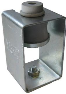
Gama diseñada para la suspensión de falsos techos acústicos y maquinaria trabajando a partir de 1.000 r.p.m. En toda la gama Akustik se mantiene el mismo elemento antivibratorio fabricado en caucho de gran calidad mecánica, especialmente diseñado para el aislamiento vibratorio. La estructura metálica es resistente a más de 650 kg y recubierta de baño electrolítico bicromatado.
