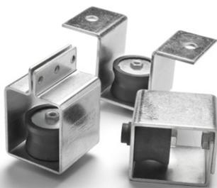
Gama diseñada para la suspensión de falsos techos acústicos y maquinaria trabajando a partir de 1.000 r.p.m. En toda la gama se mantiene el mismo elemento antivibratorio fabricado en caucho de gran calidad mecánica y especialmente diseñado para el aislamiento vibratorio. La estructura metálica es resistente a más de 1.000 kg y recubierta de baño electrolítico bicromatado.
