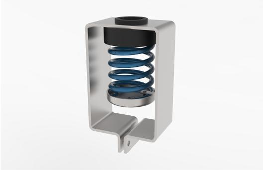
Los soportes de techo para bajas frecuencias naturales VT tipo 3 están diseñadas para soportar cargas de 5 a 150Kg por soporte. Su diseño ha sido perfeccionado para ser usado en perfiles reforzados con una forma de "i" .
